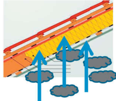
Abb. 4 und 5: Dach- und Fußbodenkonstruktionen sind sehr häufig von Schimmelschäden betroffen, ohne dass dies augenscheinlich erkennbar ist (aus 13)
