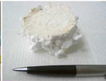
10 Die Dämmprobe bringt es an den Tag: Die Dämmung ist mikrobiell belastet
