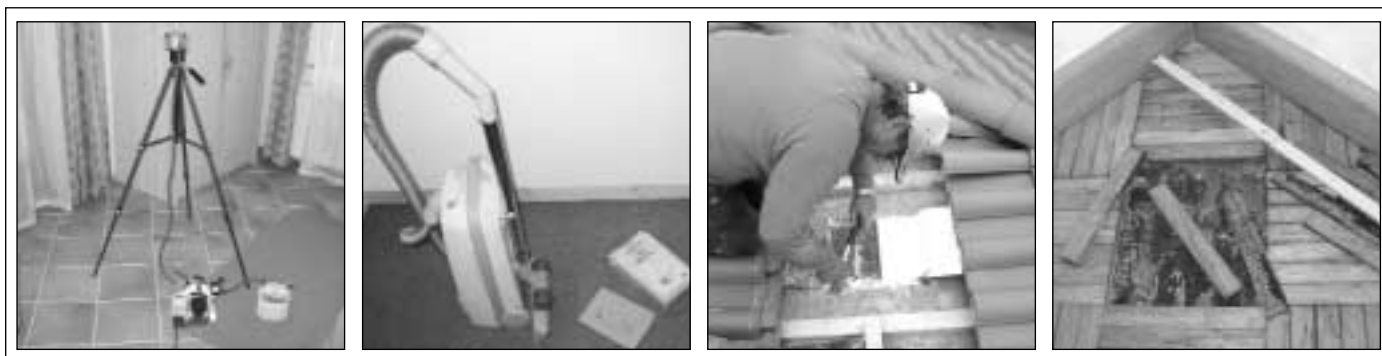
Abb. 2: Erst die Untersuchung von Raumluft, Staub und Material im Rahmen eines Innenraumchecks bringt die Sicherheit, ob eine Belastung mit Schadfaktoren in der Wohnung vorliegt oder nicht.
